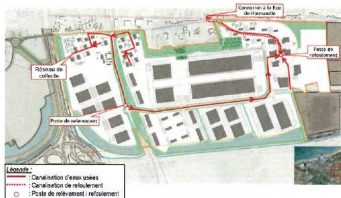
SCHÉMA DE PRINCIPE DE LA GESTION DES EAUX USEES DU PROJET DOCUMENT N° 27
